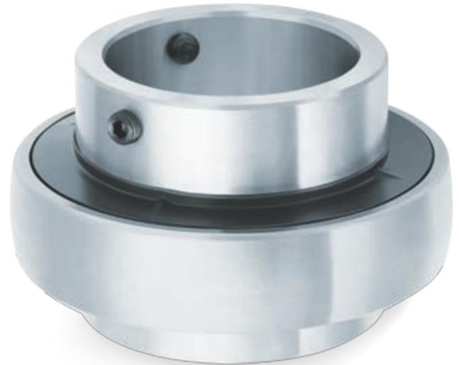
Der Innenring eines Spannlagers kann die Breite des Außenrings haben oder, je nach Anwendung, ist der Innenring ein- oder beidseitig verlängert. Die Befestigung der LFD-Spannlager auf einer Welle erfolgt mittels Gewindestiften oder eines Exzenterrings.
